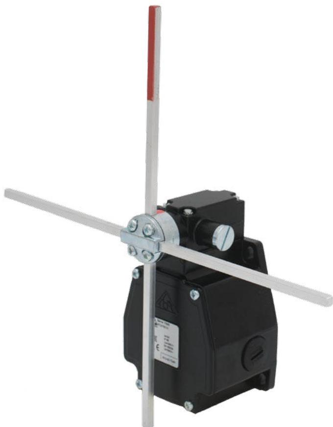
Многопозиционный концевой выключатель, также подходящий для использования в качестве абсолютного энкодера с низким разрешением, предназначенный для управления перемещением мостовых кранов, подъемников и сложных станков. Выбор материалов и принятых технических решений позволяет использовать их в тяжелых условиях эксплуатации.
