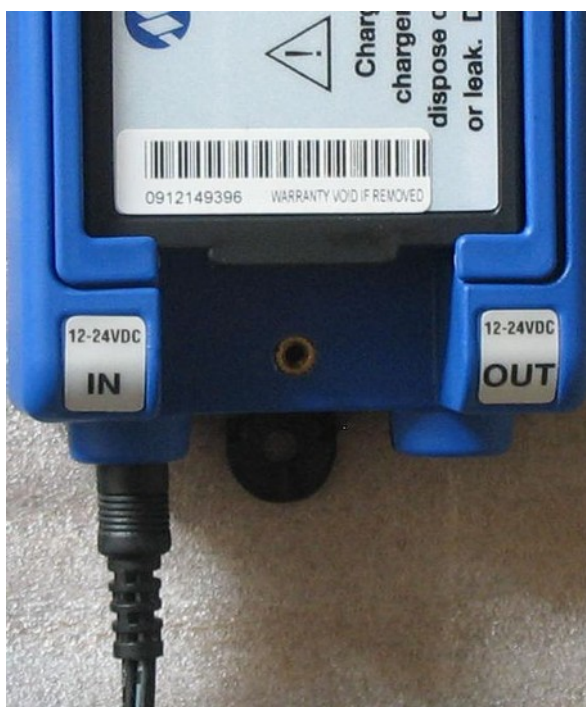
Obr. 1: Připojení adaptéru k nabíječce
