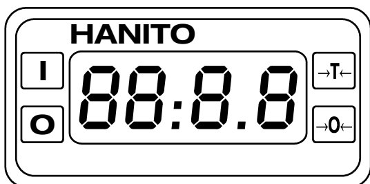
Obr. 1 – Segmenty LCD displeje
