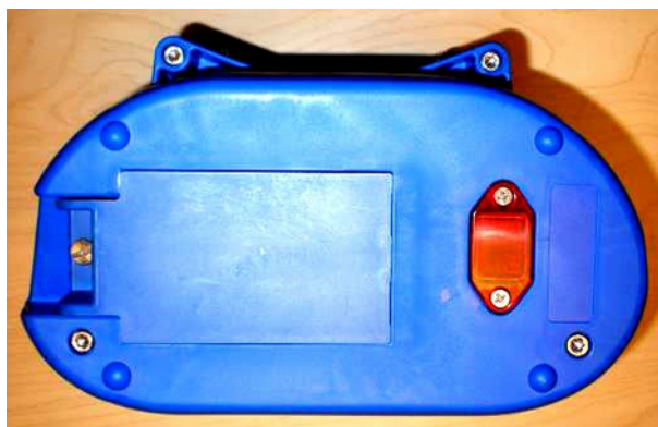
Obr. 5: Kryt prostoru baterií MLTX2
