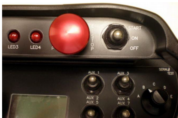
Obr. 7: STOP tlačítko a třípolohový přepínač OFF – ON – START
