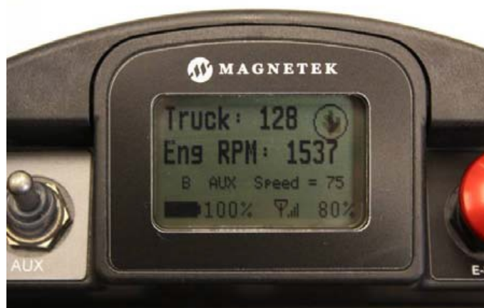
Obr. 8: Displej vysílače v normálním provozu
