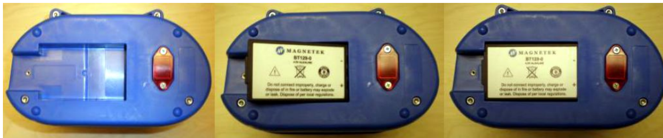
Obr. 4: Postup vložení pouzdra baterií do vysílače
